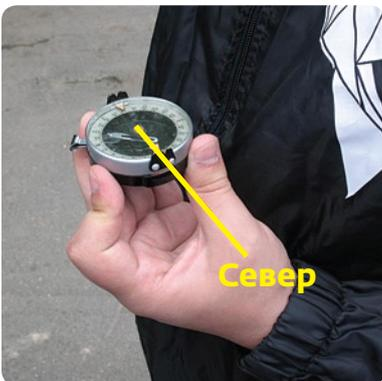
**4** Откладываем на циферблате компаса значение азимута в нашем случае это  $137^\circ$ .
