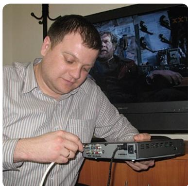
Подключите приемник к телевизору с помощью RCA кабеля «тюльпан». См. Схему Подключение устройств к приемнику стр.13 рук-во пользователя.
